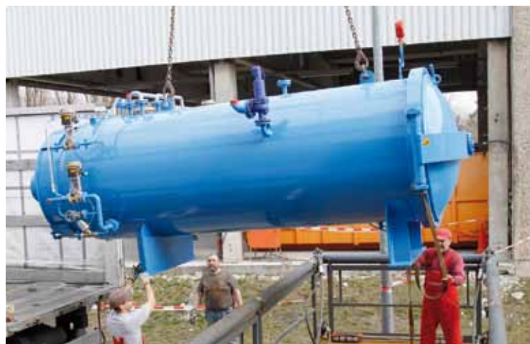
Links unten: Dr. Matthias Rottmann und Dr. Alexander Kraft (rechts) vor einer elektrochromen Verbundscheibe im Maximalformat von 100 mal 240 Zentimetern. Bild rechts entstand während der Anlieferung des Heißluftautoklaven. Er ist Teil der Pilotlinie, die die beiden Forscher vor knapp zwei Jahren in ihren Räumen im Innovationspark aufgebaut haben.
